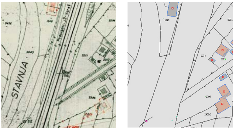
Slika 1: Analogni katastarski plan (isječak) sa mnoštvom ucrtanih detalja (lijevo) i prikaz istog područja iz baze podataka katastra nekretnina (desno) (plan razmjere 1:2500 nomenklature 6G16-20 i URL 4), plan je pohranjen u arhivi Službe za prostorno uređenje, zaštitu okolice, geodetske i imovinsko-pravne poslove općine Breza
