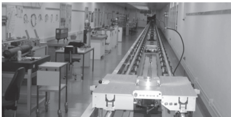
Slika 2. Kalibracijska traka na IGP, ETH Zurich (Schulz, 2007)
