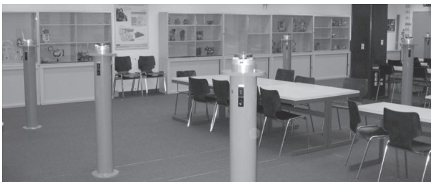
Slika 4. Mreža mjernih stubova na IGP, ETH Zurich (Schulz, 2007)
