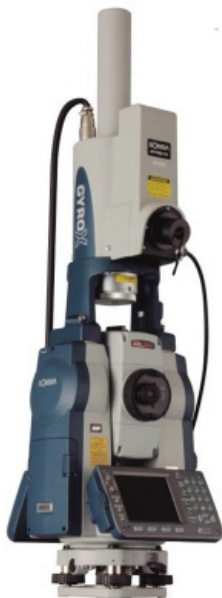
Slika 5. Žiroskopska mjerna stanica Sokkia Gyro X (GeoWILD, 2013)
