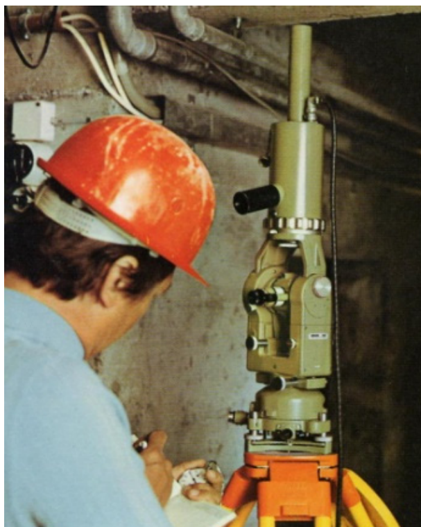
Slika 4. Teodolit Wild T2 sa žiroskopskim dodatkom GAK1 (Tuno i Kogoj, 2011)
