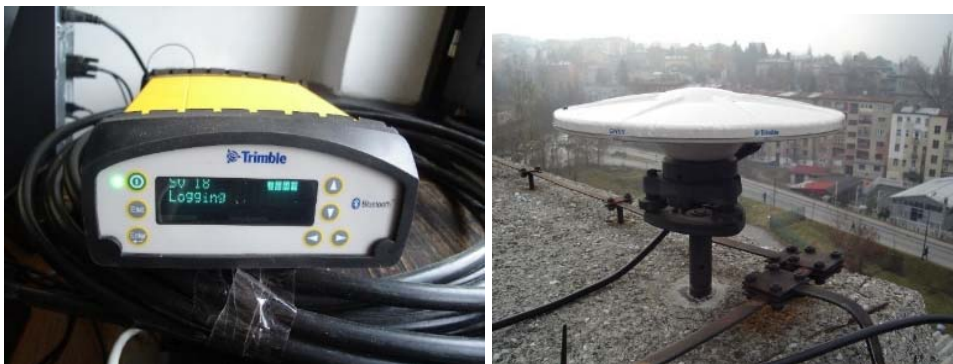
Slika 3. Prijemnik (lijevo) i antena (desno) na stanici SRJV
