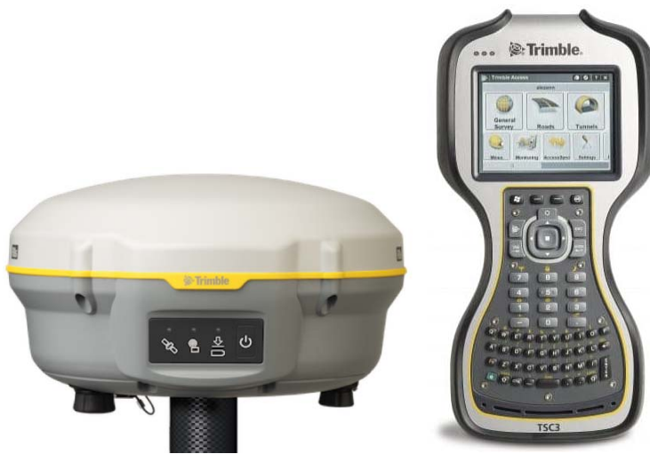
Slika 2. Prijemnici i kontroleri korišteni za mjerenje
