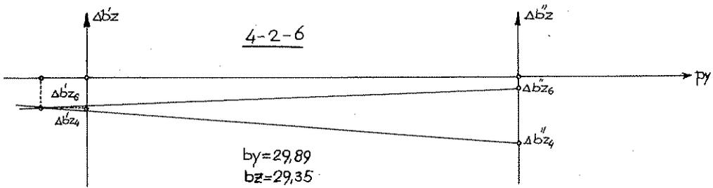
Kada zauzmemo dobivene vrijednosti:  $b_y = 29,88$  i  $b_z = 29,36$  tada mora biti  $\Delta\omega = 0$ . Na spojnici tačkaka 1 i 2 vertikalnu paralaksu  $p_y$  poništimo sa  $\omega_1$  ili  $\omega_2$ . Kada opet vratimo  $b_y = 30,00$  i  $b_z = 30,00$ , onda paralaksu poništimo sa  $k_1$  i  $f_1$ . Poslije toga model je bez paralakse. Preostalu vertikalnu paralaksu očitamo u svih 12 tačkaka sa komponentom  $b_y$ .
